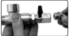
5. Avvitare il raccordo 3/8" maschio tubo ø8mm alla valvola a sfera.
