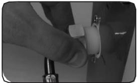
7. Avvitare il raccordo da 3/4" del tubo flessibile sull'elettrovalvola posta sul retro dell'impianto.
